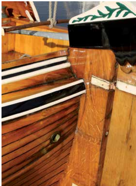
Ludana's achterschip in het polyester. Alleen de zeer goede waarnemer ziet het opgeschilderde imitatie-houtpatroon.
