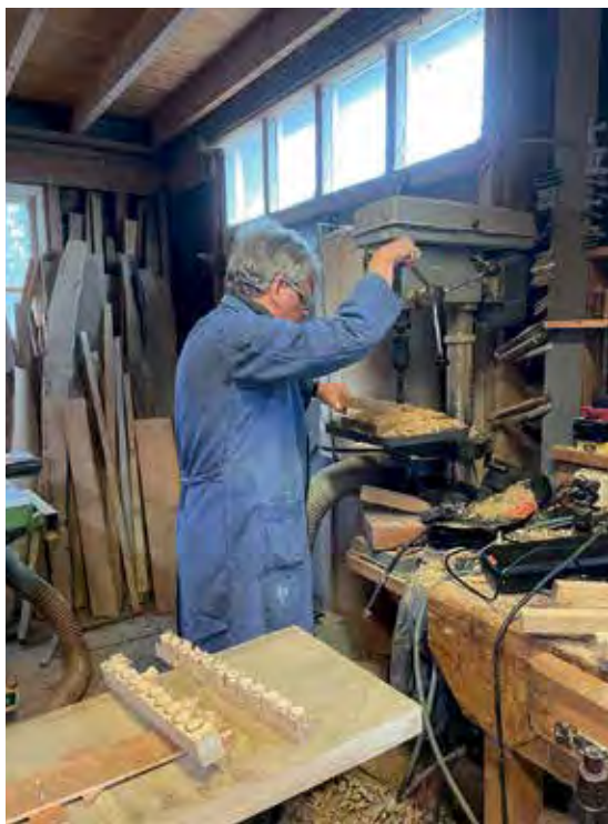
Rentmeester Jaco maakt doppen om schroefgaten in de huid af te dichten.
